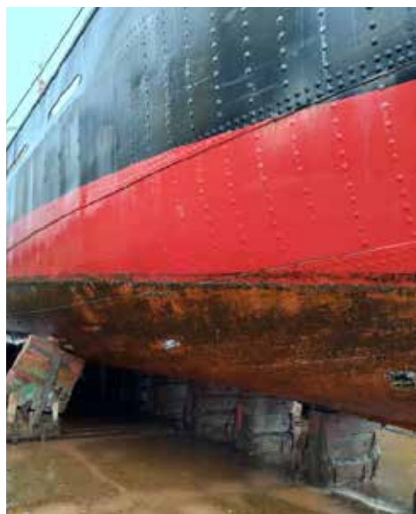
Tæringshuller i forreste skot styrbord side er blevet lappet
